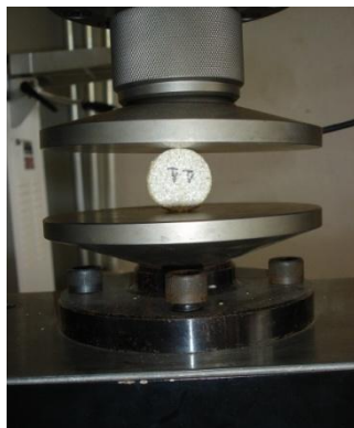
Figura 4 - Máquina Universal no momento do ensaio do briquete.
