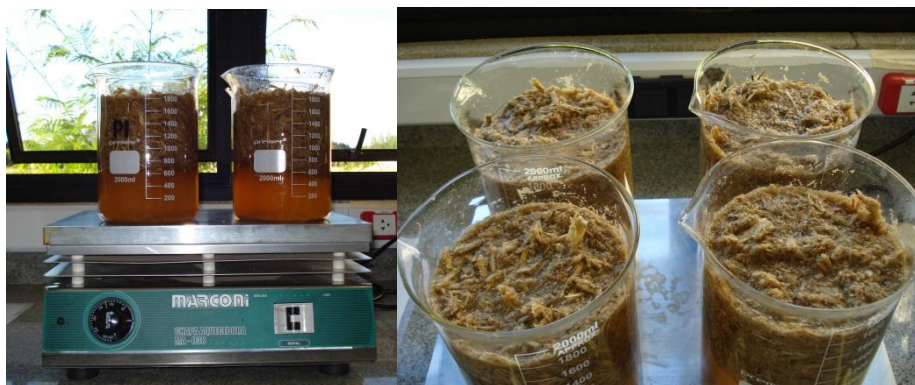
Figura 1 - Extração em água quente (70°C).
