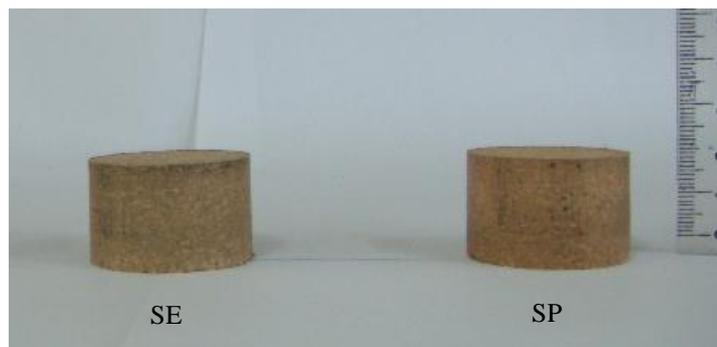
Figura 2 – Briquetes produzidos a partir da compactação das serragens de *Eucalyptus sp* (SE) e *Pinus sp* (SP).
