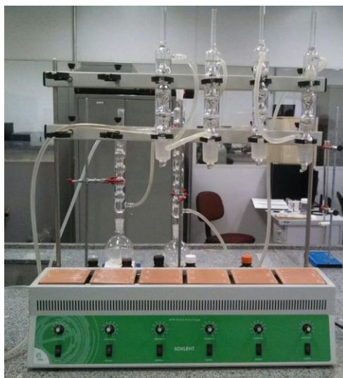
Figura 26: Extrator Soxhlet para Obtenção do Teor de Extrativos.
