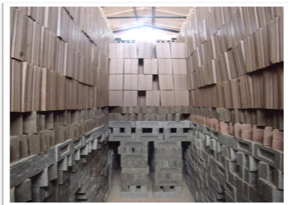
Figura 10: Empilhamento Manual dos Blocos Cerâmicos.
