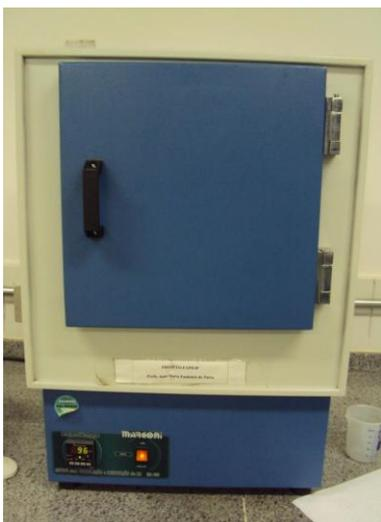
Figura 5: Estufa Climatizada para determinação do teor de umidade.
