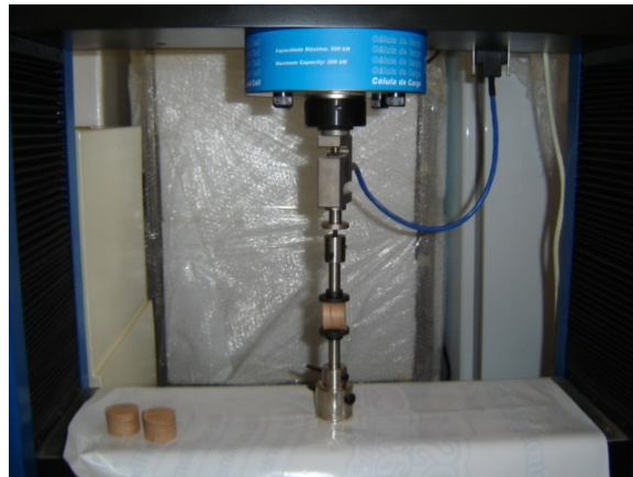
Figura 3 – Máquina Universal no momento do ensaio do briquete Universal test machine showing the test in briquette
