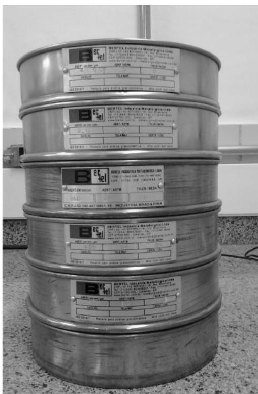
Figura 4. Peneiras utilizadas na análise granulométrica.
