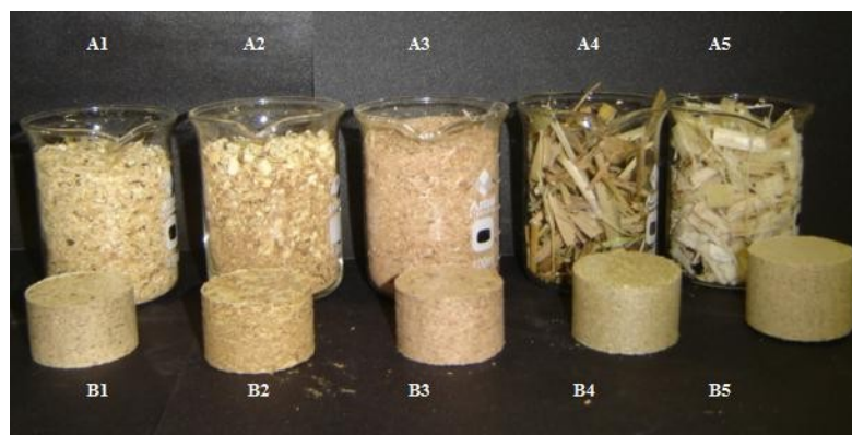
Figura II: foto representando a redução de volume dos materiais, sendo A1, A2, A3, A4, A5, os materiais antes de serem briquetados e B1, B2, B3, B4, B5 sendo os materiais após a briquetagem.
