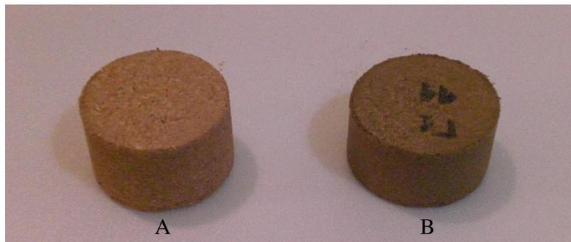
Figura 01: Briquetes mostrando a compactação dos materiais, onde: A= serragem de eucalipto e B=folhas de eucalipto.
