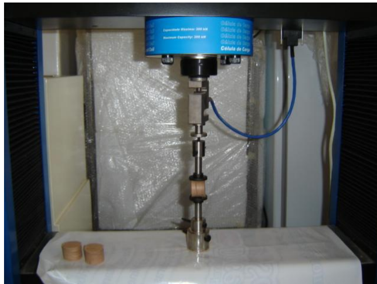
Figura 3 - Máquina universal de ensaios EMIC® DL30000N, utilizada a fim de realizar o ensaio de resistência à tração por compressão diametral.
