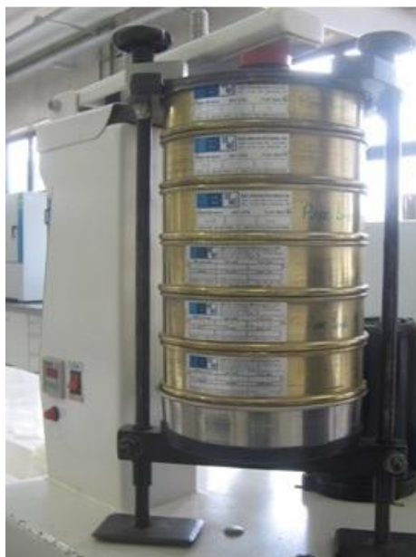
Figura 1 - Classificador de partículas, usado para a realização da separação granulométrica do material.
