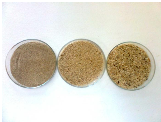
Figura 1 – Frações da serragem utilizada para o teste: Fundo, 35 mesh e 14 mesh. - Fractions of sawdust used for the test: Background, 35 mesh and 14 mesh.
