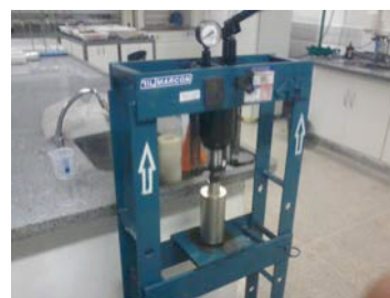
Fig. 1: Prensa para briquetagem (Fonte: TEIXEIRA, 2013).
